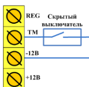
Рисунок 6.2 — Схема подключения скрытого выключателя или кнопки
